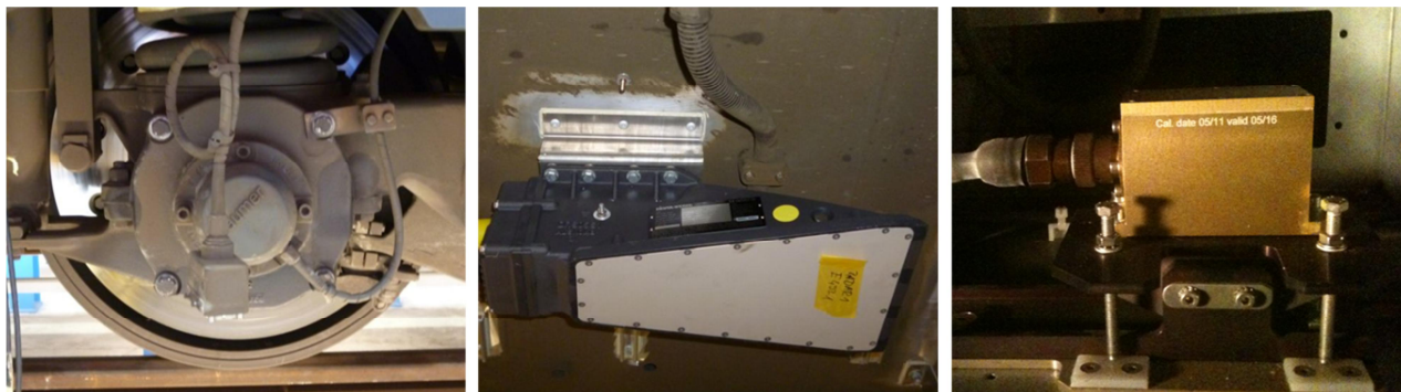
Illustration 5 Capteurs odométriques: capteur d'essieu, capteur radar et accéléromètre (de la gauche vers la droite).
