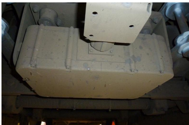
Illustration 3 Antenne de balise ETCS.
