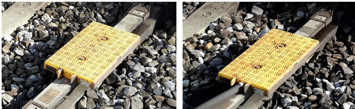
Illustration 2 Balises à données fixes et variables (de la gauche vers la droite)
